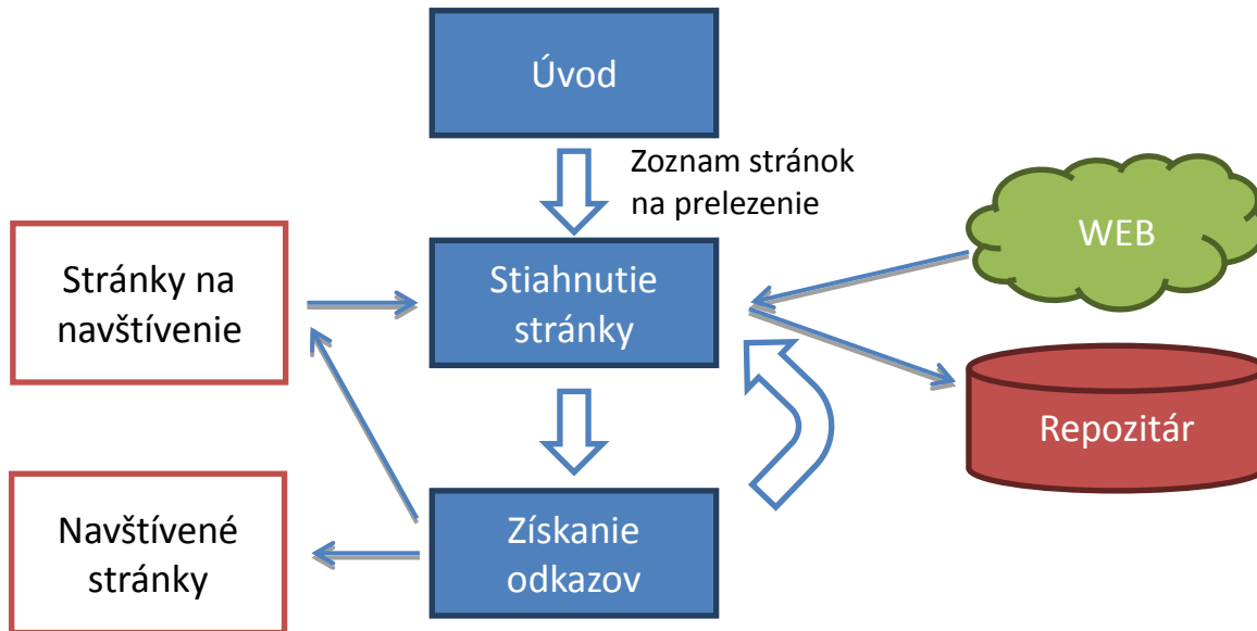
Obrázok 29. Schéma preliezača. Preliezanie sa začína úvodným krokom cez zoznam URL. Následne sa tieto URL prechádzajú, získavajú sa nové adresy a zaraďujú sa do repozitárov.
