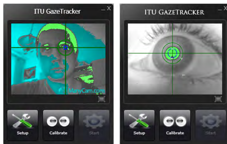
Obrázok 2: Porovnanie riešenia GazeTracker pri použití bežnej webovej kamery zo štandardnej pozície (vľavo) a blízko umiestnenej kamery s infračerveným prísiviením (vpravo – prevzaté zo stránok riešenia 9 ).
