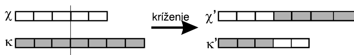
Obrázok 4.23. Operácia kríženia dvoch m-chromozómov, tieto si vymenia svoje časti nasledujúce za náhodne generovaným bodom kríženia. Operácia kríženia mení, vo všeobecnosti, dĺžku m-chromozómov.
